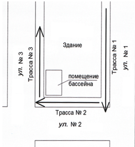
Рис. 1. Схема трасс георадарного обследования основания здания на примыкании к помещению бассейна
